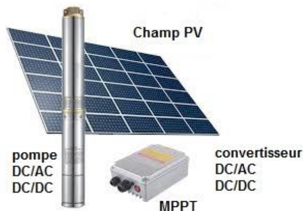
Figure II. 19: Diagramme du pompage PV par motopompe [42].
