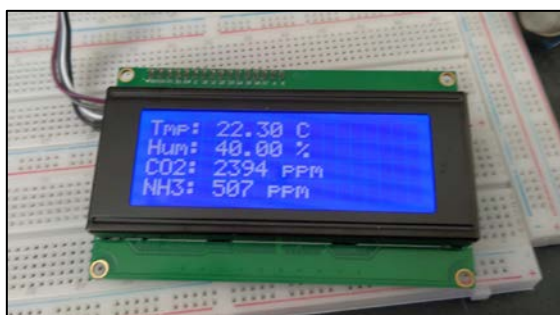
Figure 26 : Valeurs des capteurs sur l'écran LCD I2C
