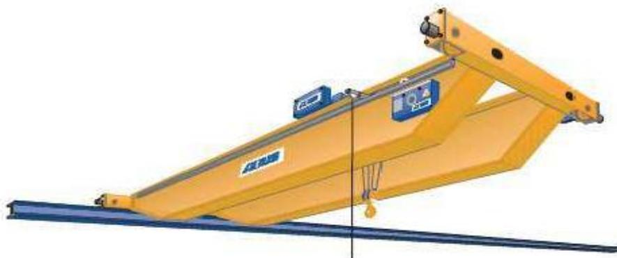
Figure 4.1 : Schéma 3D du pont roulant
