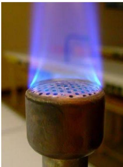
**Figure 3:** Combustion complète du butane.
