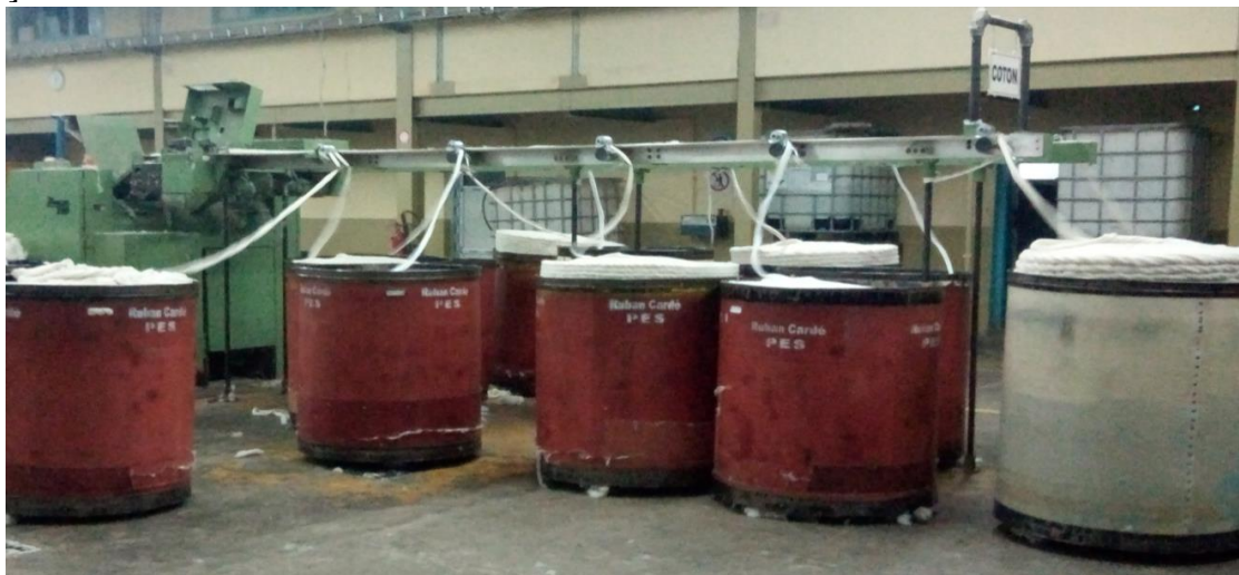
Figure 3.4. Dispositifs d'alimentation du banc d'étirage
