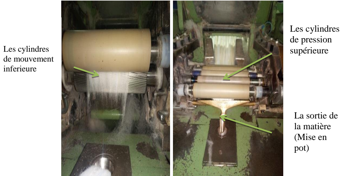
Figure 3.5. Passage de la matière à travers les cylindres
