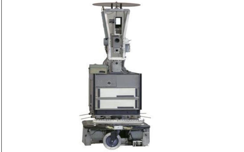
Figure 1.3: Shakey de Stanford : Une plate-forme pour les recherches en intelligence artificielle [9]
