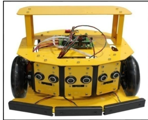
Figure 2.2 : Robot mobile avec deux roues motrices indépendantes au milieu du corps principal [97].
