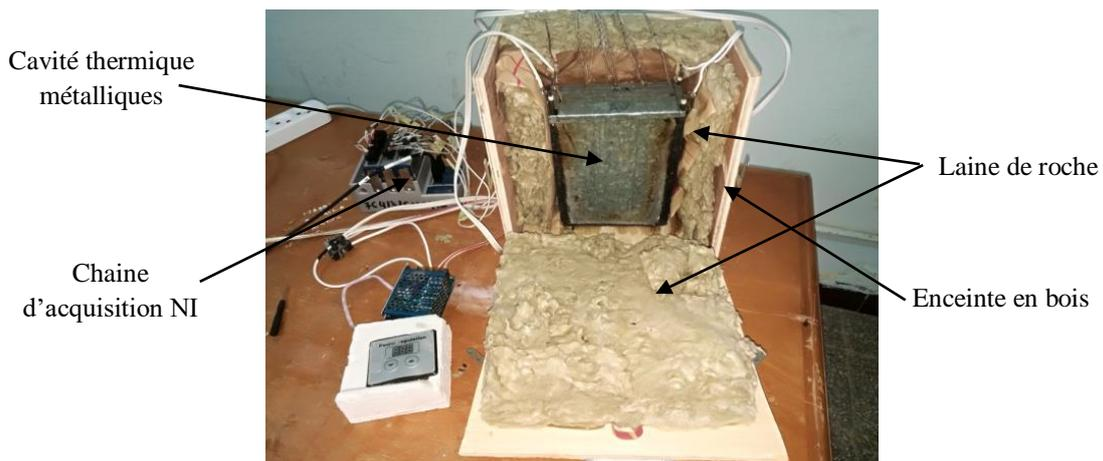
**Fig. 3.3. Isolation de la cavité thermique**
