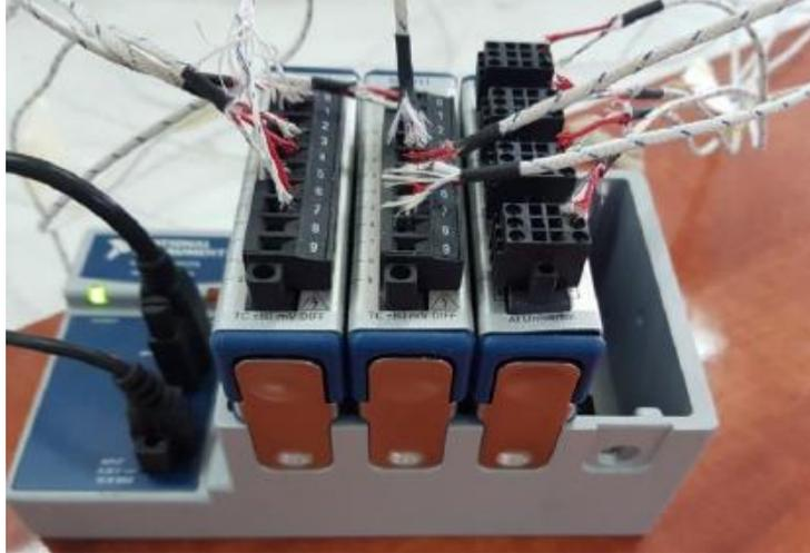
**Fig. 3.6. Module d'acquisition NI avec les capteurs de température.**
