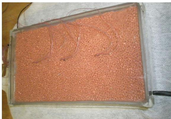
**Fig.1.3. Photo de la mousse de cuivre imprégnée par la paraffine [6].**
