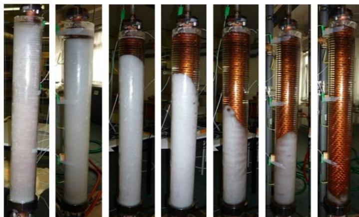
**Fig.1.4. Profils de fusion de la paraffine dans l'échangeur à ailettes en cuivre, à différents instants [7]**
