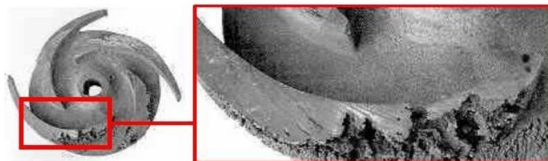
Figure 36: Effets de la cavitation
