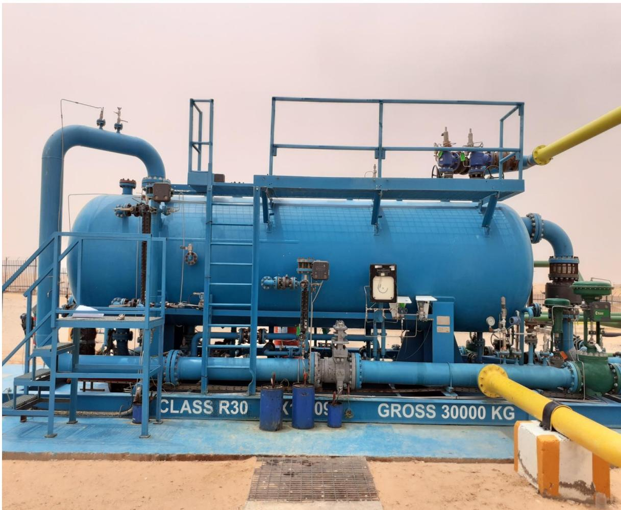
Figure 48: Séparateur 2160 psi au niveau de manifold HGAW [9]
