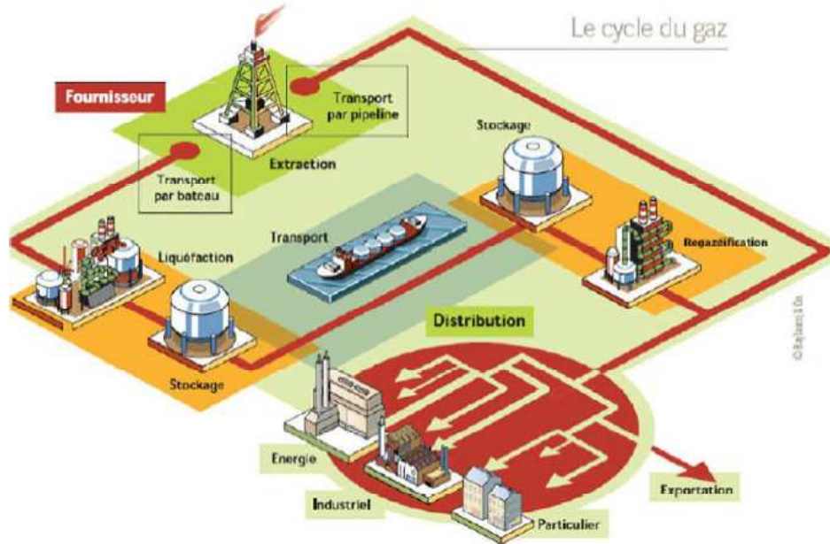
Figure5 Processus de Transformation de gaz Naturel.
