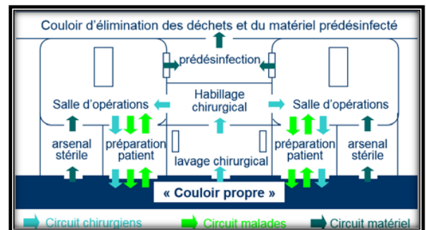
Figure 131: salle d'opération à double circuit.
