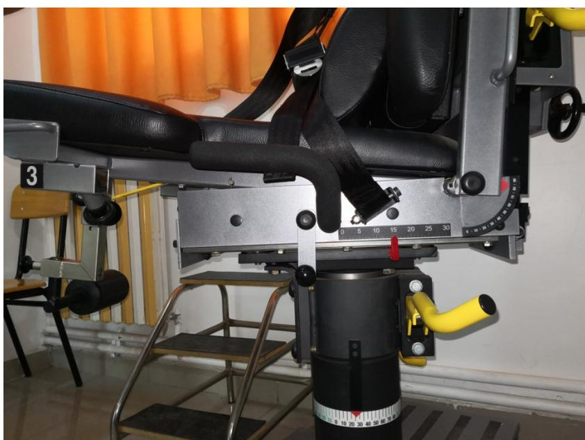
Figure05 : Le siège est couplé avec le réglage avant et arrière du dossier ainsi qu'un harnais 4 points s'adapte parfaitement à toutes les morphologies.
