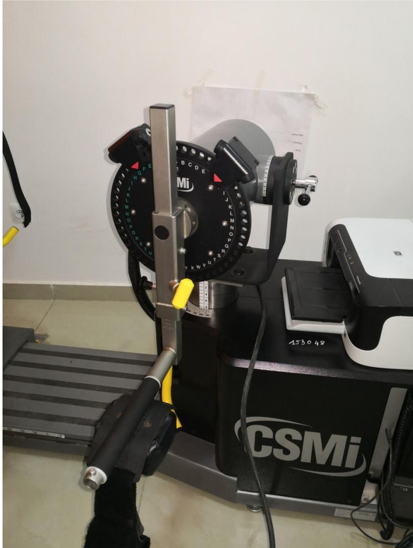
Figure06 : Le dynamomètre ; les buttées mécaniques ; l'accessoire du genou.
