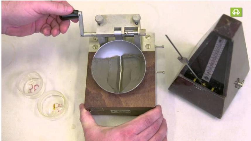
**Photo III.8 : Appareil de Casagrande pour déterminer la limite de liquidité**
