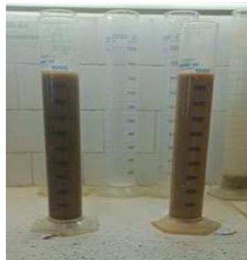
b. Essai de sédimentométrie
