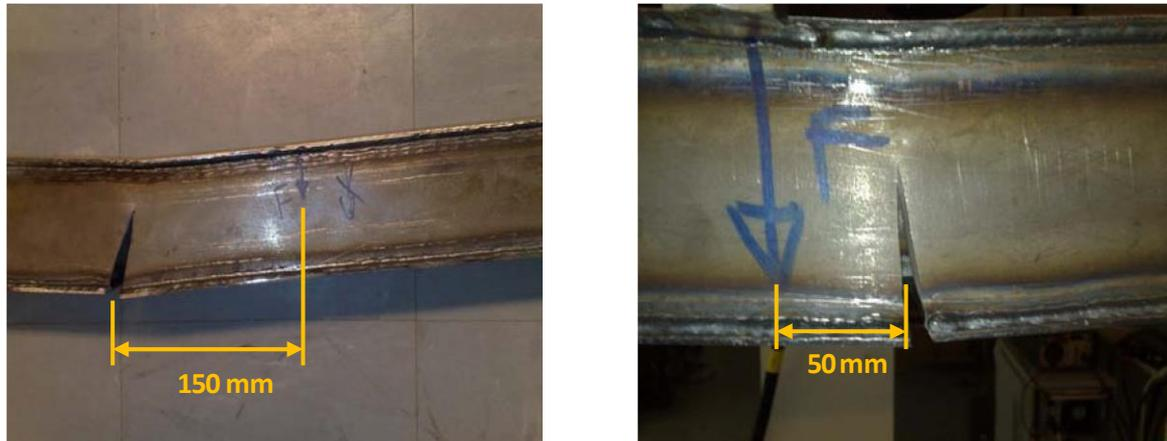
Figure 40 : Rupture loin du moment de flexion maximal [15]
