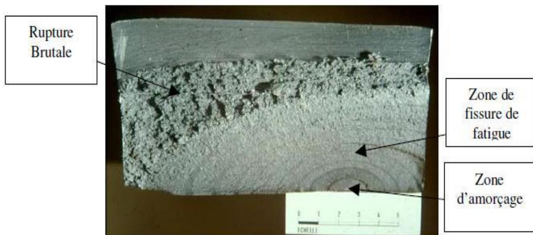
Figure 26 : Faciès de la rupture [13]
