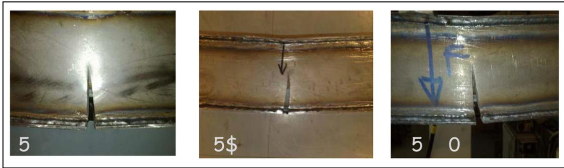
Figure 37 : Rupture des caissons testé [15]
