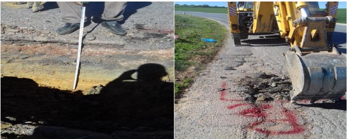
Figure 4-3 corps de chaussée en puits n°2
