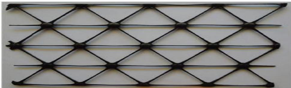
Figure 1-15 Géogrille triaxiale
