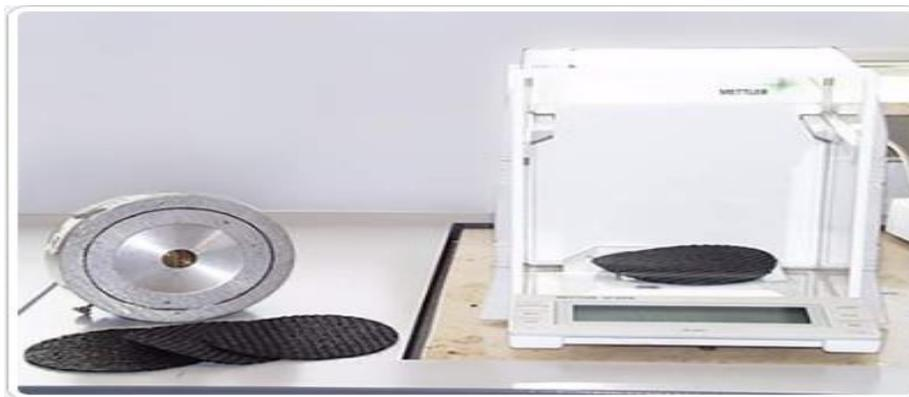
Figure 1-22 Essai de détermination de la masse surfacique
