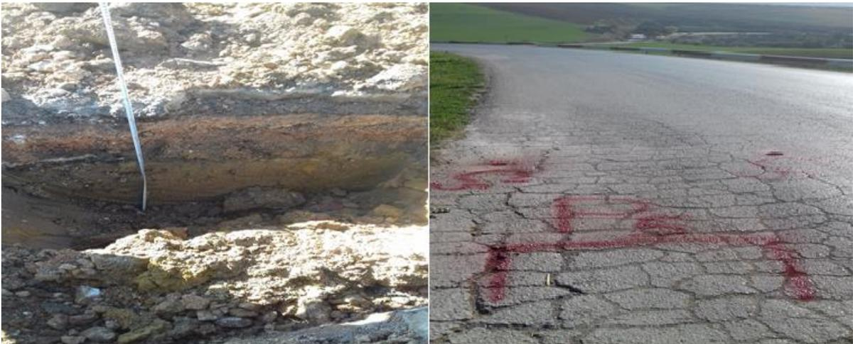
Figure 4-6 corps de chaussée en puits n°5
