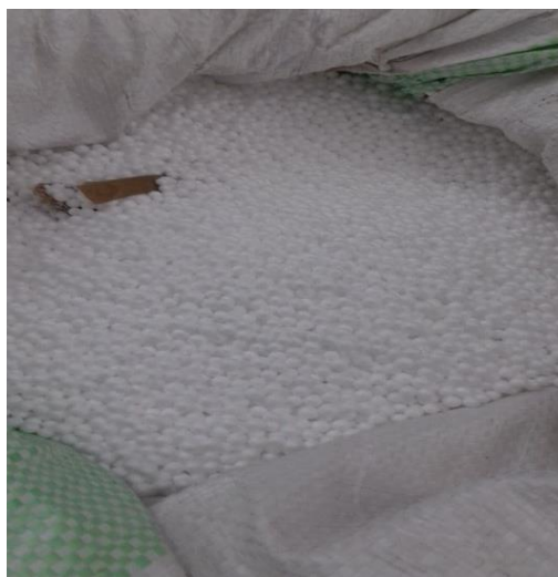
Figure I-9: Polystyrène expansé (photo prise au laboratoire)
