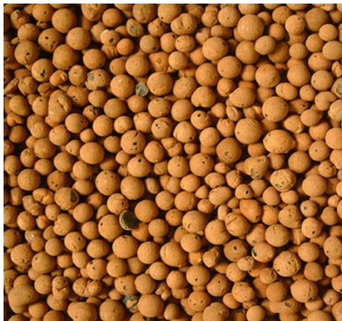
Figure I-2: Argile expansé (tiré de : jnina.tn)
