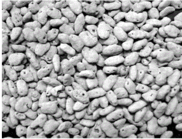
Figure I-5: Cendres volantes frittées (tiré de : aquaportail.com)
