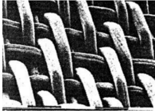
b. Géotextile tissé de monofilament
