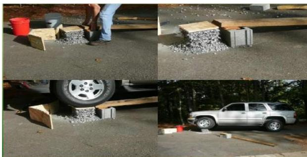
**Figure 2-20 :** Essai avec un véhicule sur une case contenant des couches granulaires+géogrille
