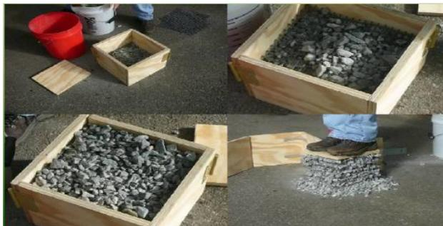
**Figure 2-19 :** Essai d'un homme sur une case contenant des couches granulaires+géogrille
