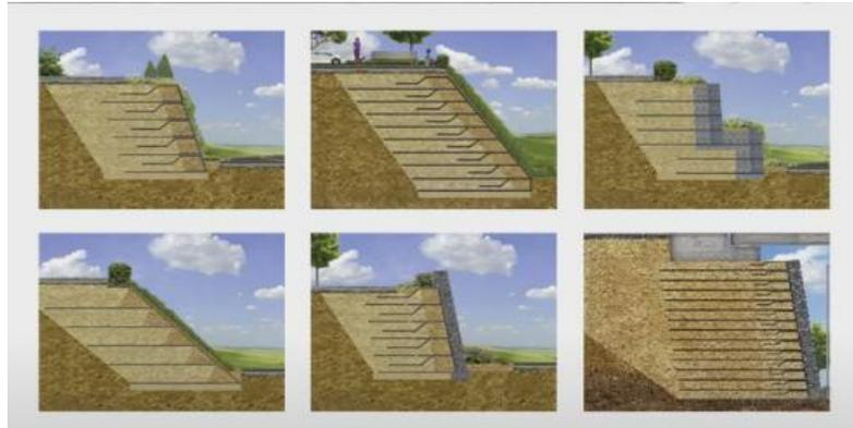
**Figure 3-4 :** Les différents cas de parements qui peuvent être utilisés dans un massif de sols renforcés par géosynthétique
