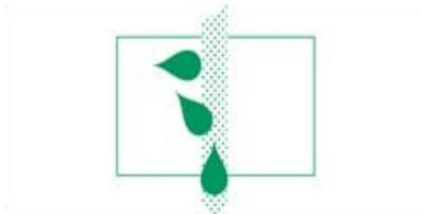
**Figure 2-11** : fonction de drainage
