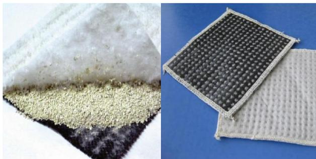
**Figure 2-9** : les géosynthétiques bentonitiques
