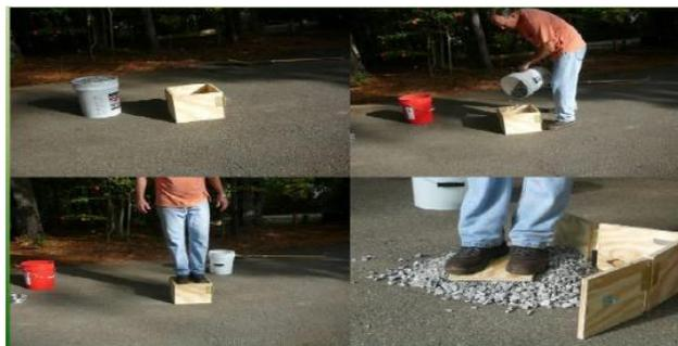
**Figure 2-18 :** Essai d'un homme sur une case contenant des couches granulaires sans géogrille
