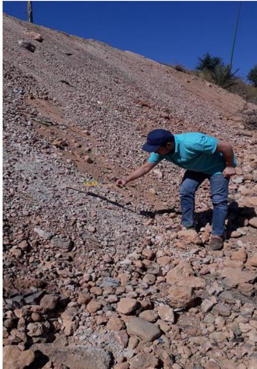
**Figure 4-21** : photo montrant mesure de l'angle de la pente sur le site d'étude
