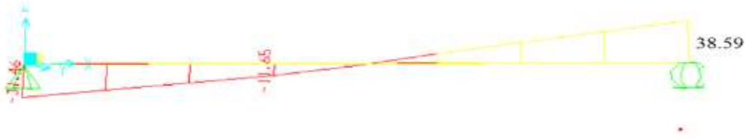
Figure III .5 : Diagramme des moments fléchissant et efforts tranchants à l'ELU
