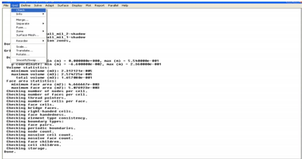
Figure 3. 15 : Vérification du maillage sous Fluent
