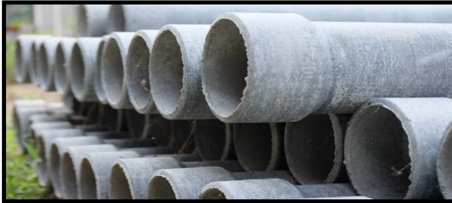
Figure II.11 : Conduite en amiante-ciment. [18]
