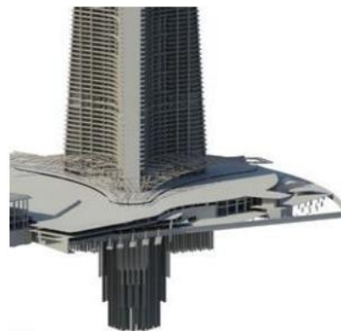
Figure 183 : système de frottement
