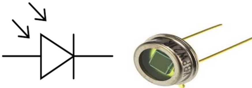
Figure I-5 : Image et symbole d'une photodiode.
