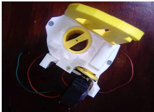
FIGURE 3.27 – Mécanisme à vis sans fin pour la rotation de l'épaule
