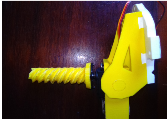
FIGURE 3.28 – Servo-moteur attaché à côté de l'épaule
