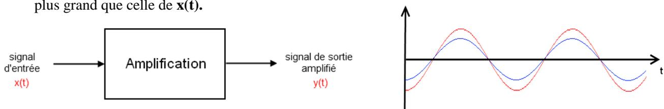
**Fig 2.11 : Principe d'amplification**
