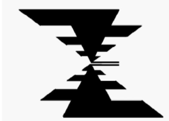
**Figure II.9:**Antenne log-périodique trapézoïdale.
