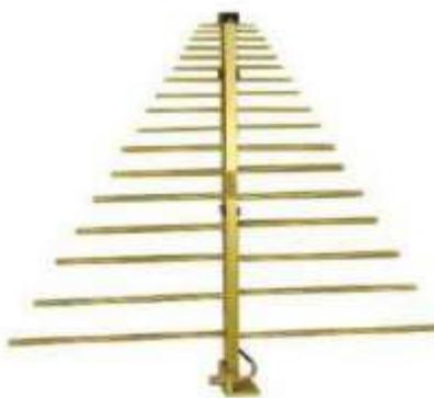
**Figure II.10 :**Réalisation pratique d'une antenne LPDA.
