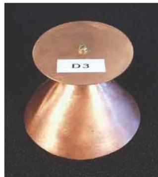
**Figure II.16 :** Antenne discône.
