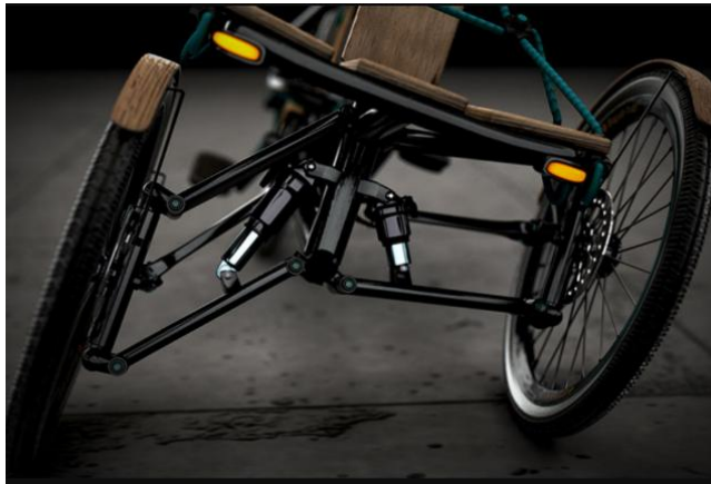
Figure 17: système de parallélogramme a quatre bras
