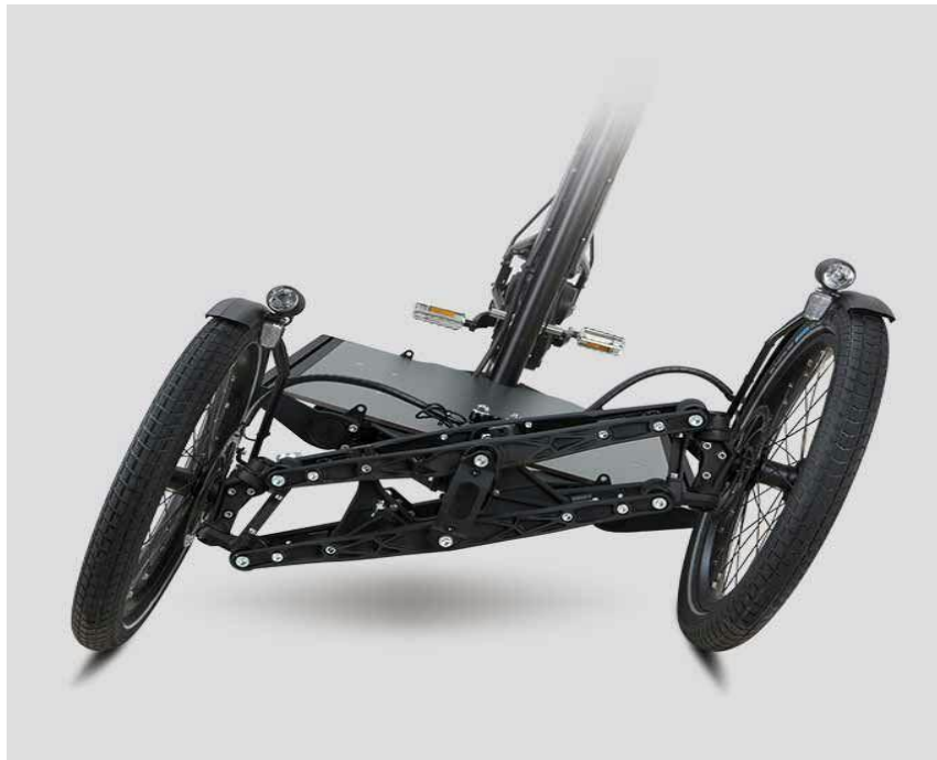
Figure 16: système de parallélogramme a deux bras
