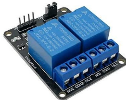
Figure II.45: Relais à 5 Volt
