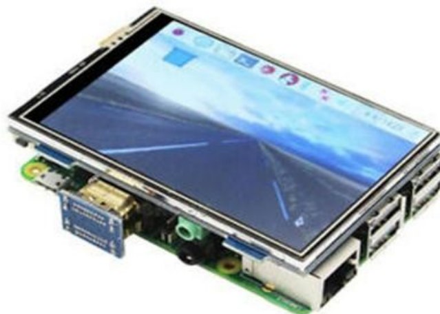
Figure III: Ecran LCD '5' TFT pour Raspberry Pi
