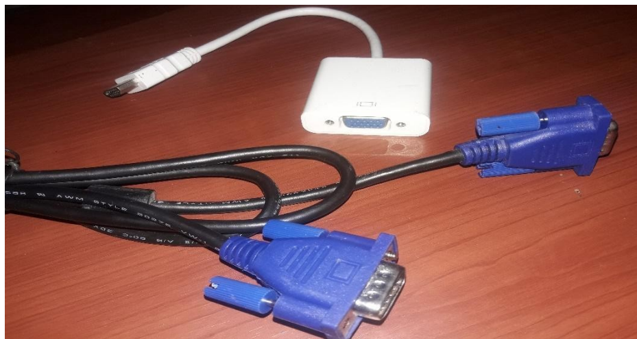
Figure II.19 : câble VGA avec un adaptateur VGA –HDMI
