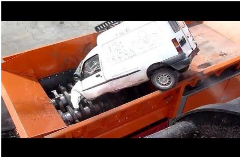
Figure 13: broyeur des voitures deux arbres [6]
