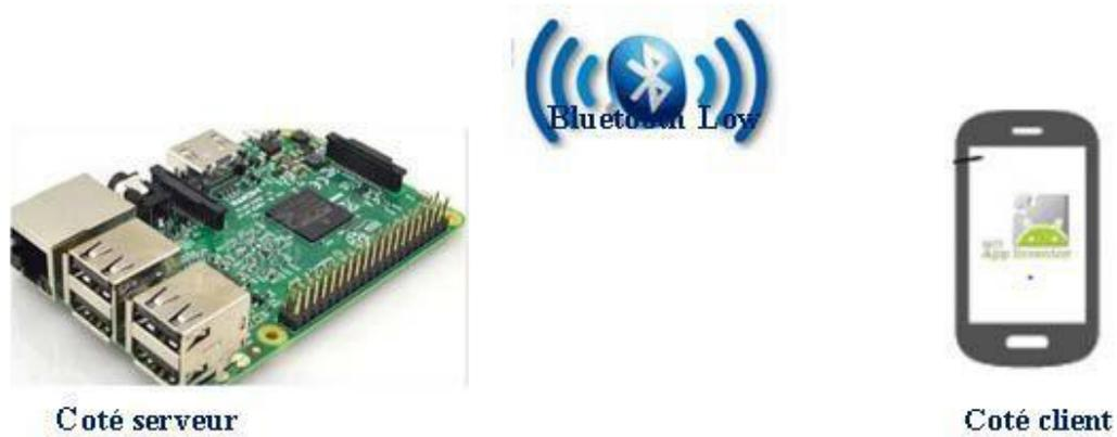
Figure II.17 : Connexion Bluetooth entre Raspberry pi et le smartphone
