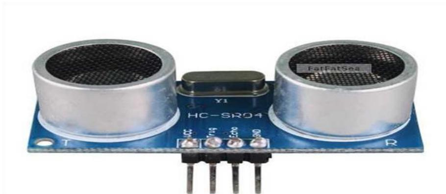
**Figure II.9** Module de télémétrie ultrasonique HC-SR04
