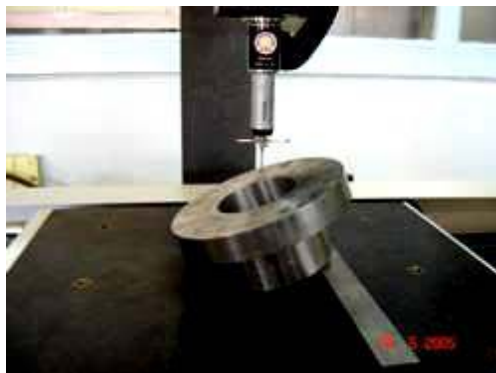
Figure 4-12 Contrôle de la planéité du palier sur MMT [20]
