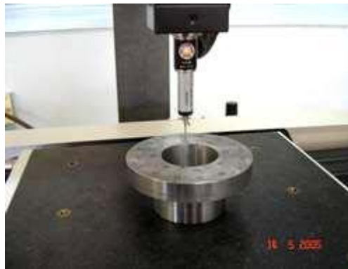
Figure 4-11 Contrôle de la planéité du palier moteur sur MMT du Laboratoire de Métrologie (ENP d'Oran) [20]
