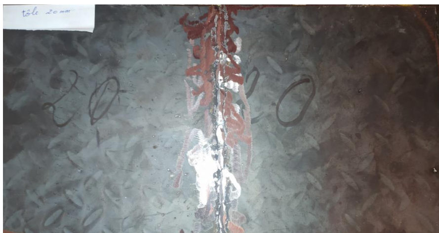
Figure 60 : Forme de l'échantillon après le soudage
