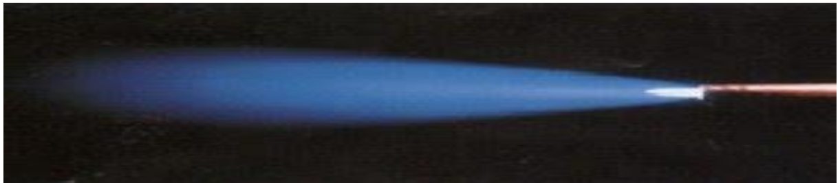
Figure 4 : Flamme chalumeau normal – Réglage parfait
