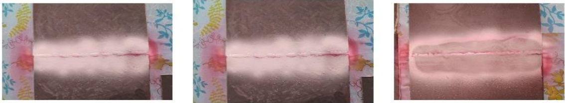
Figure 67 : Les défauts détectés dans les pièces après ressuage.
