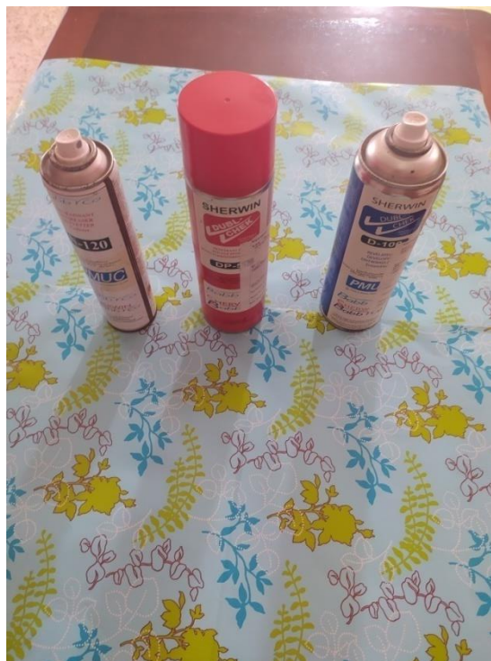
Figure 62 : Les produits utilisés dans opération de ressuage
