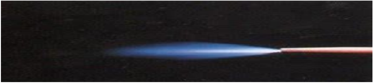
Figure 5: Flamme chalumeau oxydante – Mauvais réglage – excès d’oxygène
