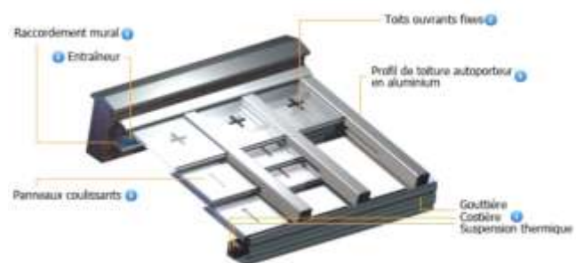
Figure 118 : Toiture vitrée Coulissante
