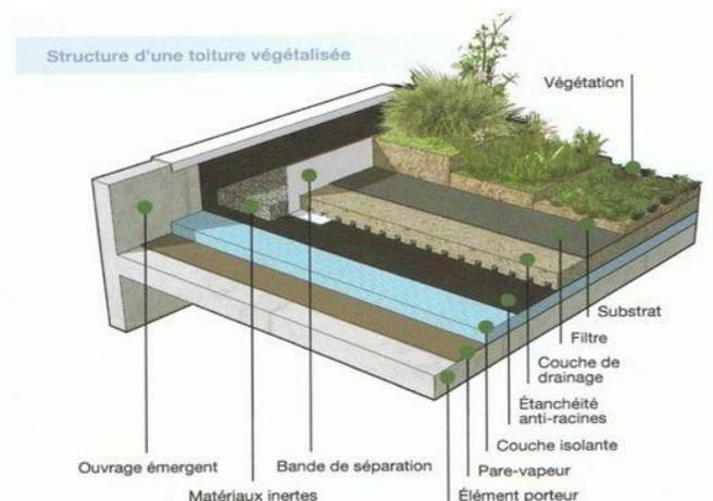
**Figure 48 : les composant d'une toiture végétalisée**Source : <https://www.pinterest.ch/>
