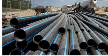
Figure 143: Canalisation extérieur en PEHD
