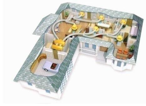
Figure 165: Système de climatisation gainable
