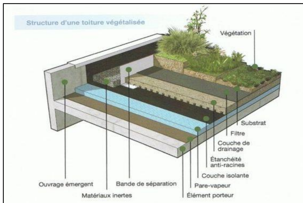
Figure 80 : Composante d'une toiture végétalisée (Source : https://i.pinimg.com/originals/ )
