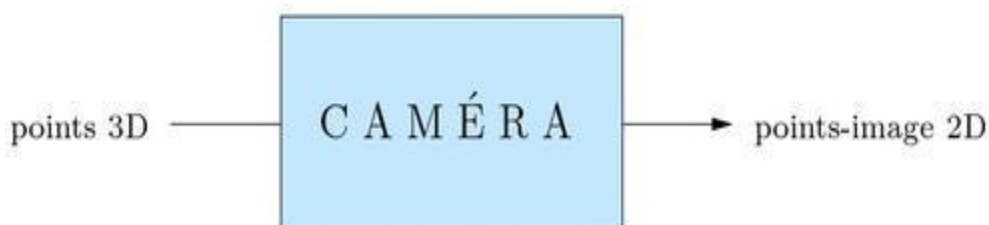
Figure 1 : Calibrer une caméra consiste à estimer sa fonction de transfert
