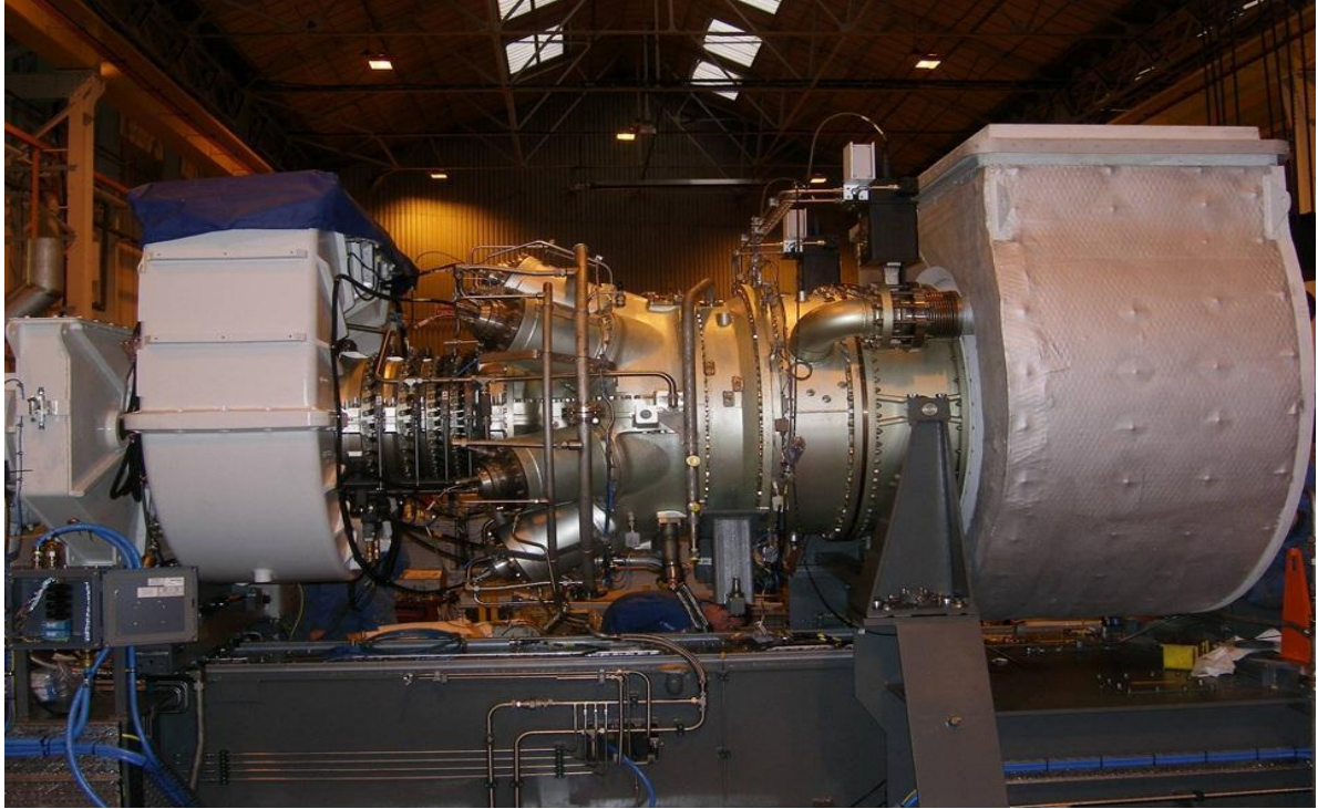
Fig. IV.4 : Turbine à gaz SGT-400
