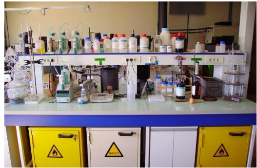
Photo 38. Paillasse fixe d'un laboratoire de chimie analytique. Le plan de travail est vitré. Caisson technique central équipé d'une rampe de prises électriques, de deux bénitiers (avec robinets à eau de ville) ; coffres de sécurité avec serrure pour produits inflammables (jaunes) ou corrosifs, caisson mobile.
