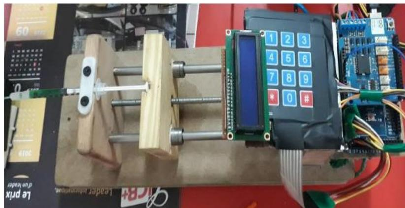
Figure II. 11: Pompe d'injection microfluidique développé au laboratoire du génie biomédical de Tlemcen[25]
