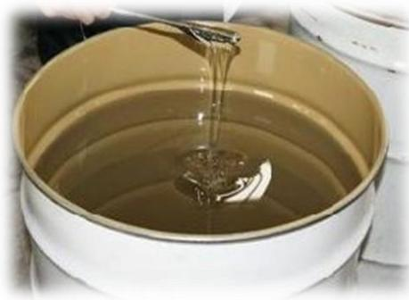
**Figure II. 9: Le polydiméthylsiloxane commercial utilisé sous conditionnement (Sylgard 182)**
