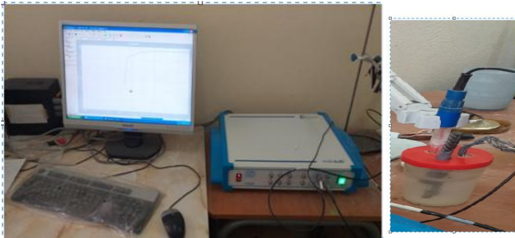
Figure 3.2 : Dispositif de mesures électrochimiques avec une cellule électrochimique
