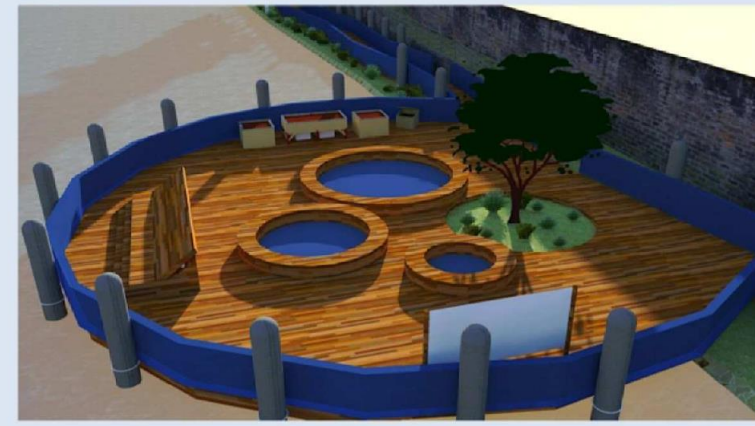
Illustration des pylônes, permettant à la promenade de suivre la hauteur d'eau de l'III en cas de crue , ibid
