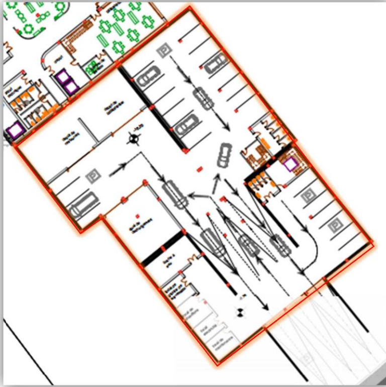
Figure 131 : emplacement des murs de soutènement, source: auteur
