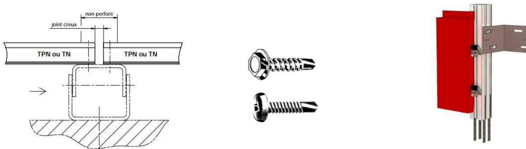
Figure 147 : fixation des panneaux de la tôle perforée métallique 86
