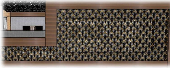
Figure 146 : panneau en tôle perforé, source : auteur Fixation par vis auto perceuse au pas de 300 à 400 mm dans la bordure non perforée.
