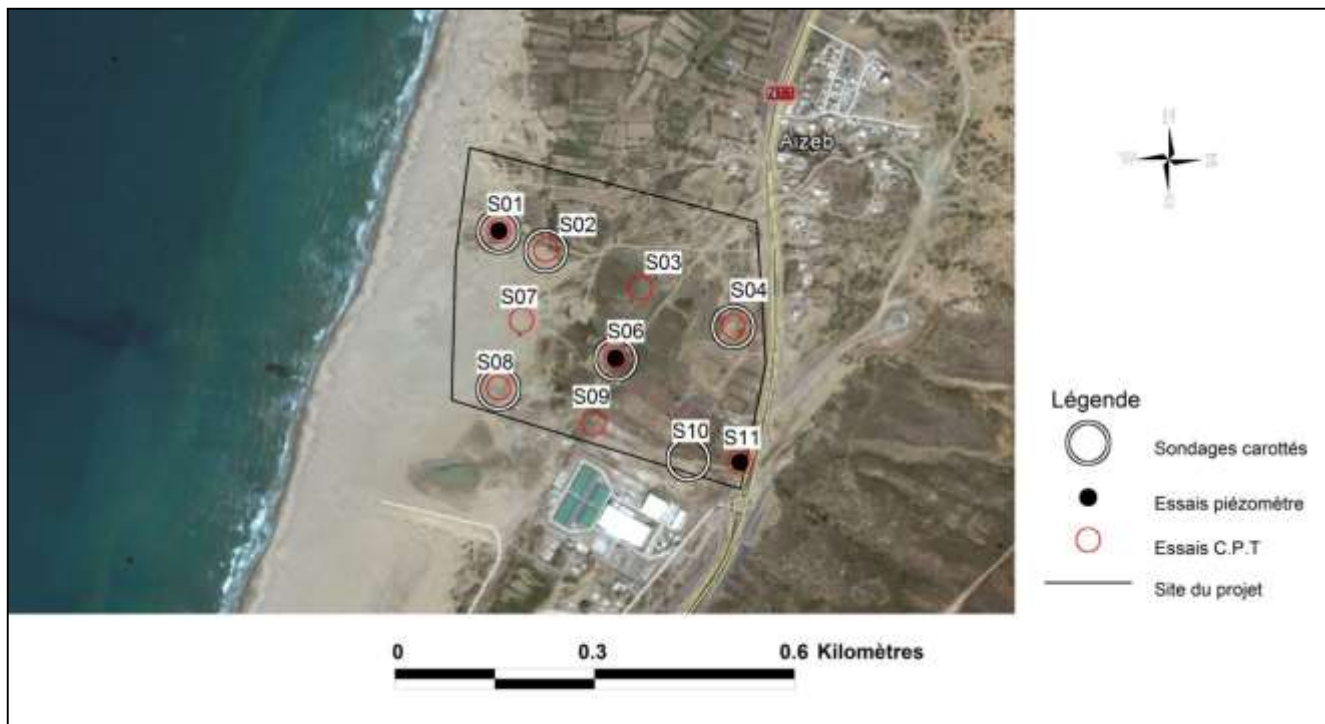
Figure 28: l'implantation des sondages dans le site d'étude.
