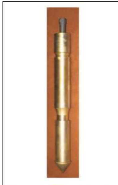
Figure 15: Exemple de point pénétrométrique
