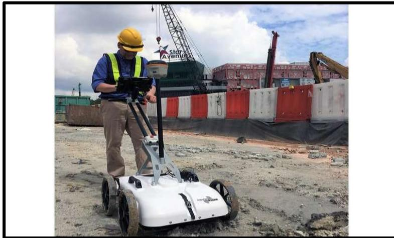
**Figure II.16:** Radar à pénétration de sol (GPR) [42].
