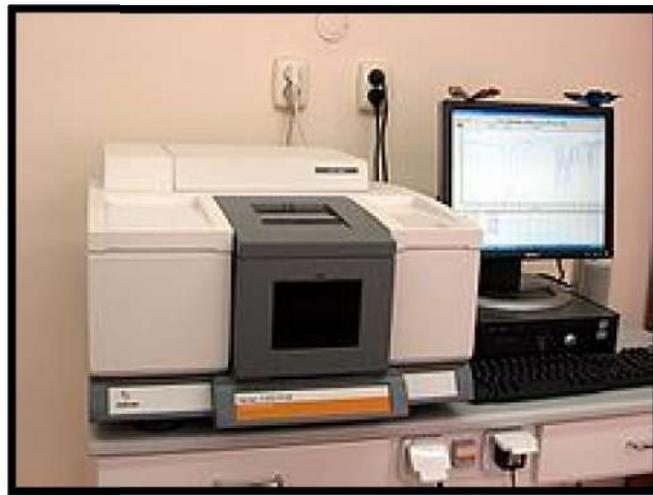
**Figure III.7:** Spectromètre infrarouge[64].
