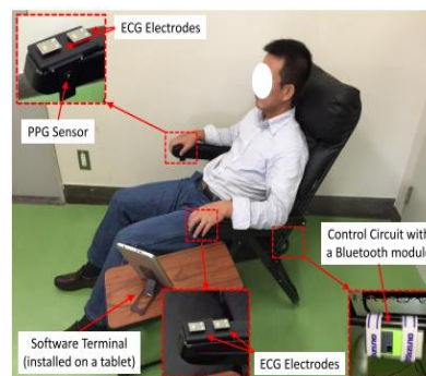
Figure III.5 ECG et PPG intégré à la chaise [63]
