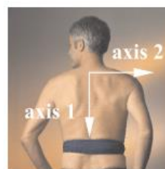
Figure III.11 Une ceinture avec ECG et accéléromètre intégrée [73]
