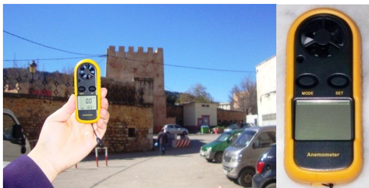
Figure 93: Instrument « Anémomètre CR2032 » pour mesurer les données microclimatiques locales dans le site urbain historique de Bad el Hadid.
