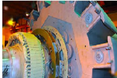
FIGURE I.6 – Rotor à pôles saillants
