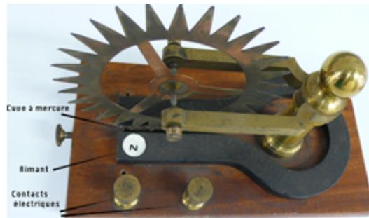
FIGURE I.1 – Dispositif expérimental de la roue de Barlow
