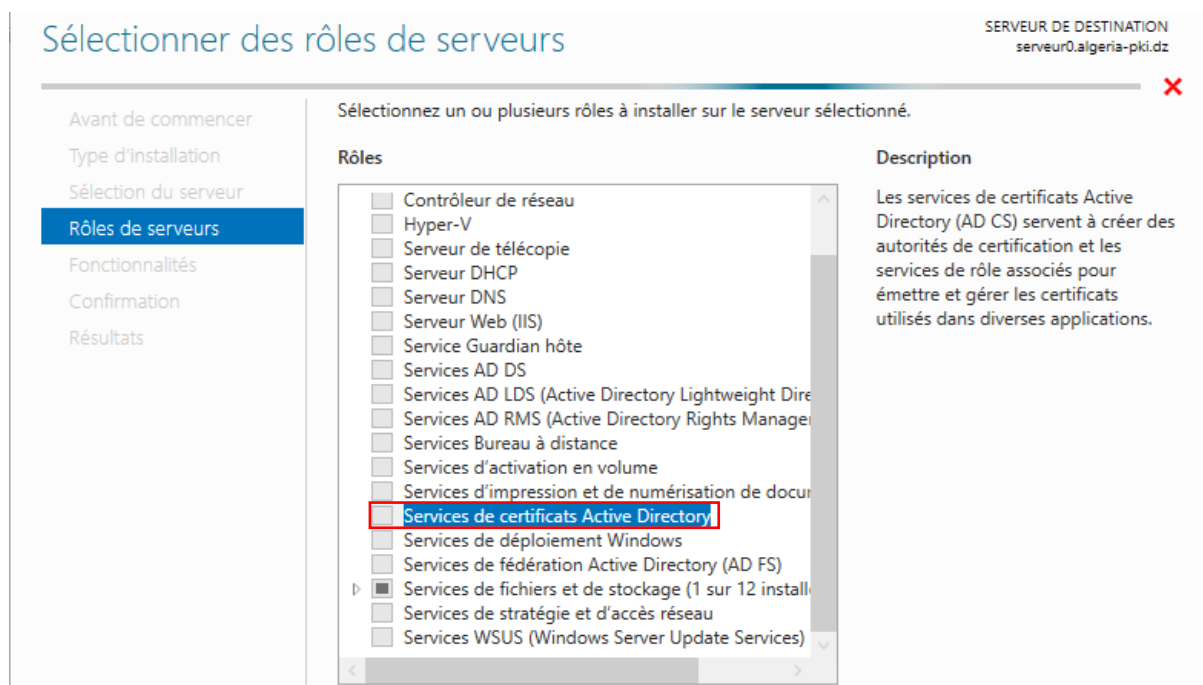
Figure 4.19 Installation d'une autorité de certification racine 1/3
