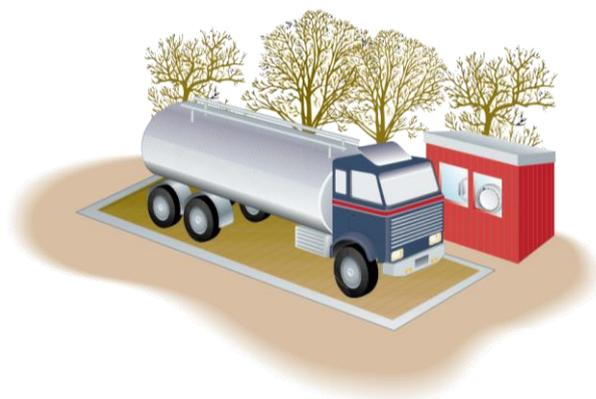
**Figure I.7 Réception de lait- Mesure au poids sur un pont-bascule.**
