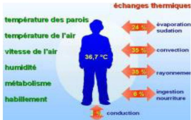
Figure I.5: Les pertes thermiques du corps humaines.
