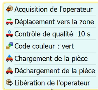
Figure 0.26 Séquence de tâches de l'operateur
