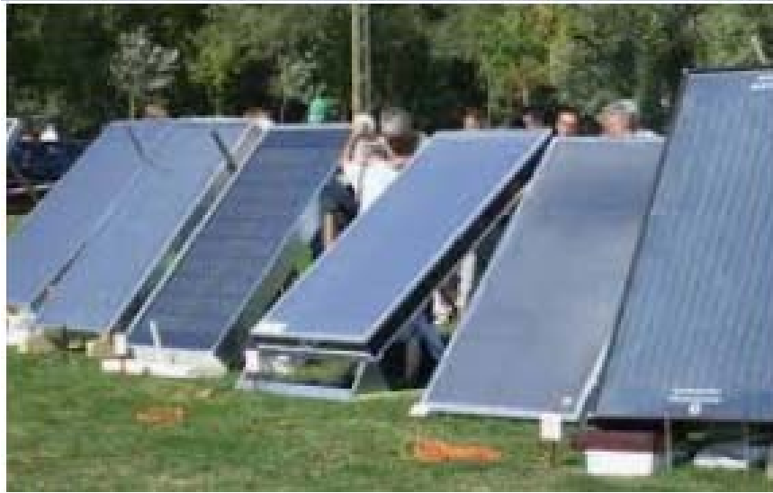
Fig. I.11 Capteur solaire plan à air [17]
